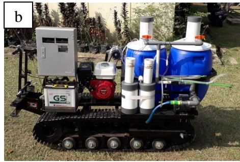
Tampilan konstruksi robot fertigasi lada TA 2018 (a) dan hasil modifikasi pengembangannya pada TA 2019 (b)
