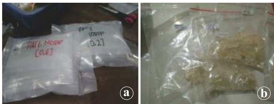
Gambar 1. Hidrogel AA-tapioka modif jahe (a) sebelum dikeringkan; (b) sesudah dikeringkan
